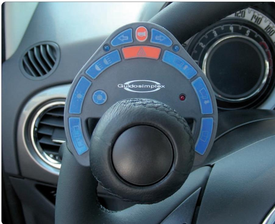
El panel de control con pulsantes, que se puede fijar en ambos lados del volante, permite al conductor accionar sin problemas los comandos de luces, indicadores de dirección, limpiaparabrisas, bocina, etc. Para facilitar la visión nocturna es posible iluminar el teclado.
