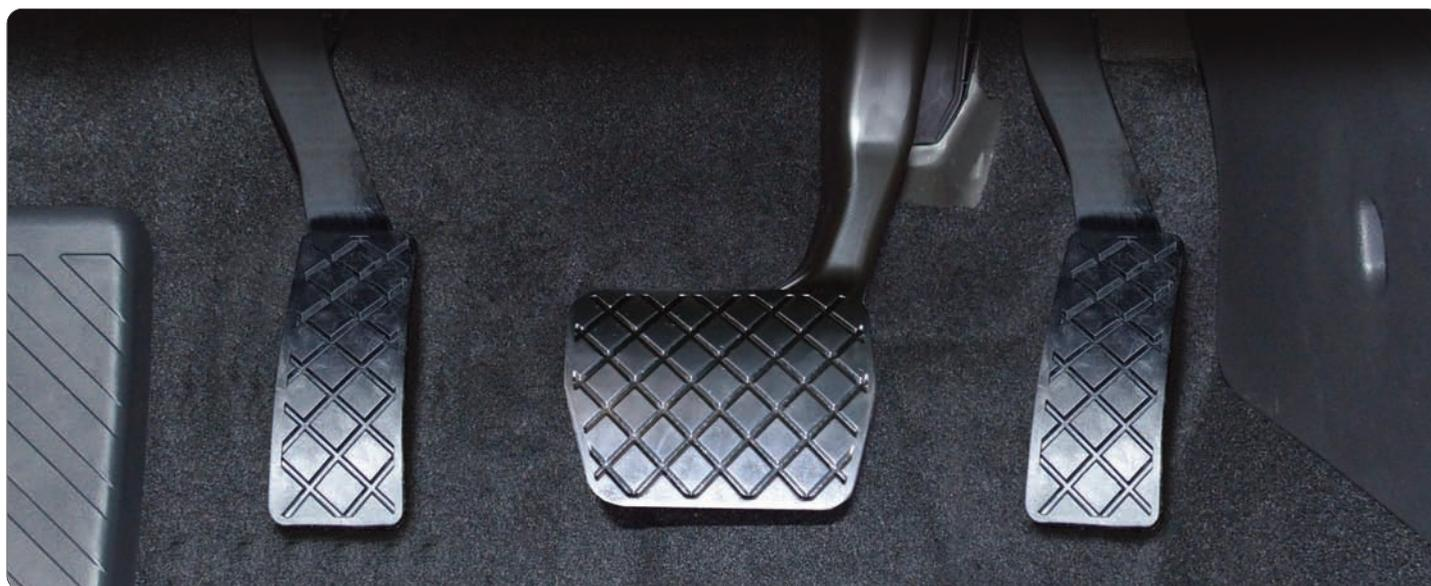
El pedal electrónico 908WF de acelerador al lado izquierdo se puede instalar en todos los vehículos con cambio automático y donde el pedal original del acelerador sea electrónico. Cuando se enciende el automovil el usuario podrá decidir si usar el pedal original o el pedal izquierdo 908WF a través de un simple interruptor, en cualquier caso y por seguridad el vehículo siempre será operativo con el pedal original.
