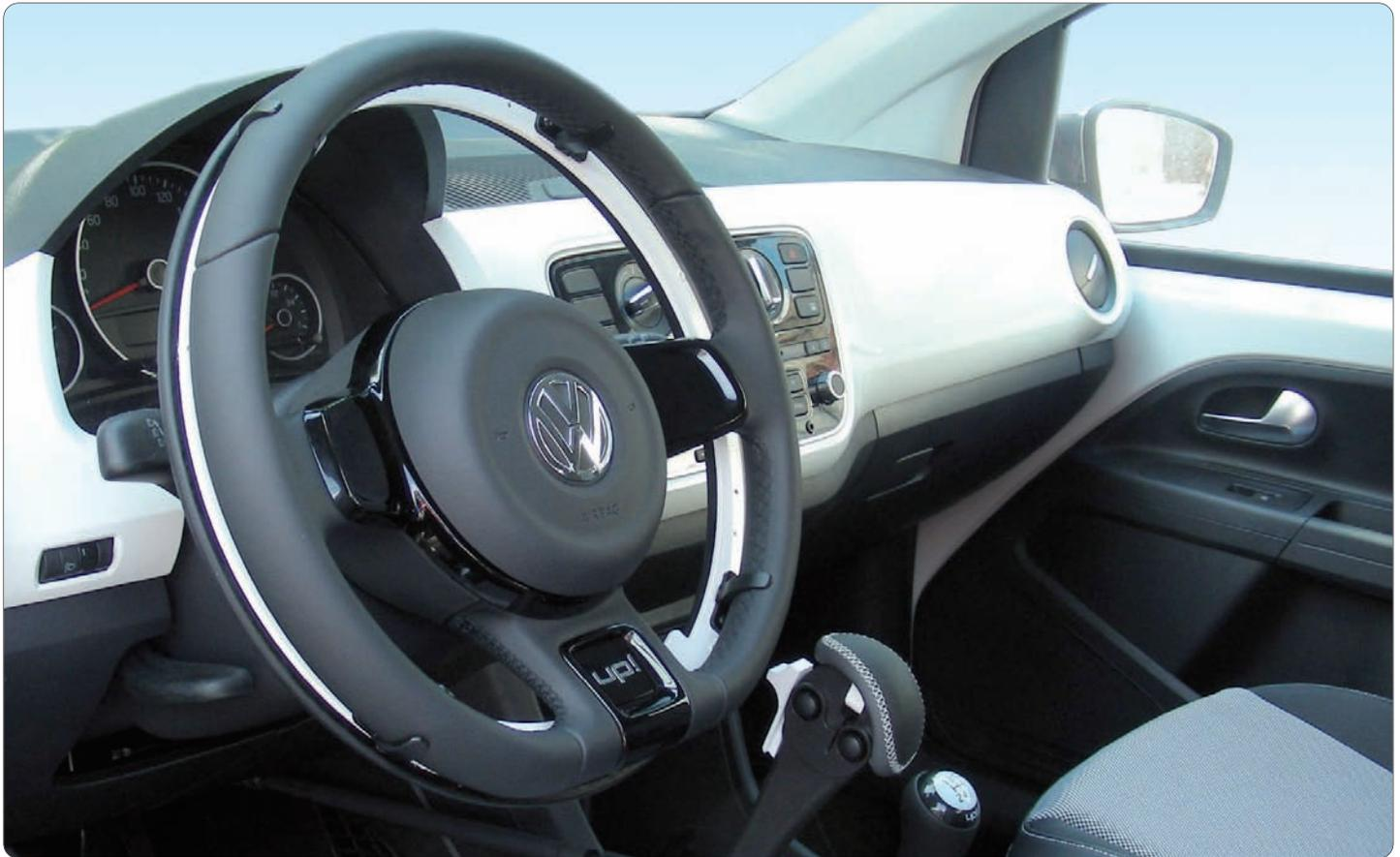
El diseño único hace que sea un dispositivo discreto, casi invisible, de ahí el nombre de "Ghost" o fantasma. Ghost es un sistema de aceleración innovador y revolucionario que permite al conductor acelerar con toda comodidad ya que está firmemente colocado debajo el volante. Para acelerar es suficiente un suave movimiento rotatorio hacia abajo, en sentido horario o antihorario.
