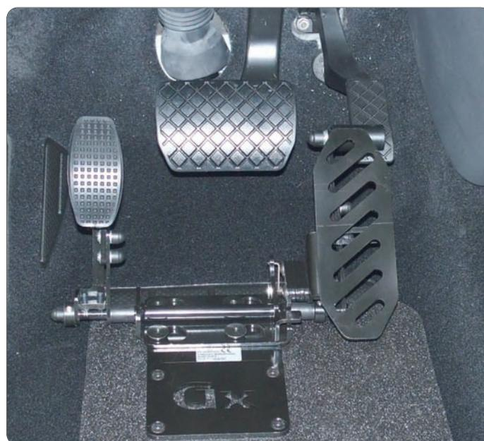
Permite acelerar con la pierna izquierda, y ha sido estudiado de modo que si es necesario, se pueda restaurar rápidamente el uso del acelerador de la derecha. Este dispositivo se personaliza para cada vehículo, y en caso de instalación en los vehículos equipados con transmisión manual, se acopla junto a un servo embrague. Por razones de seguridad el dispositivo se completa con un protector de pedal de acelerador original, en caso de que no se haya eliminado por completo.
