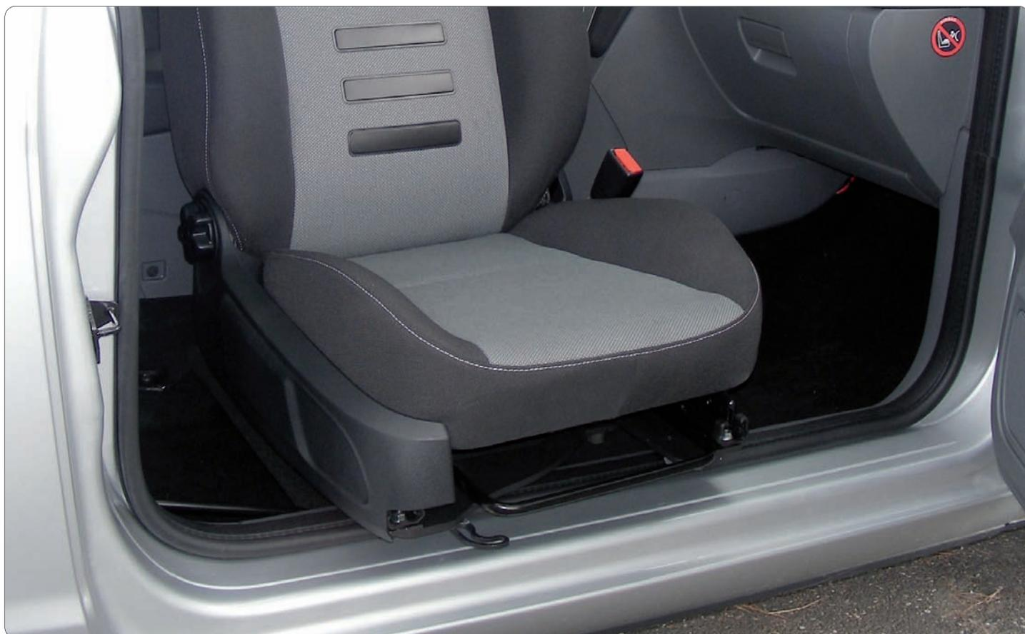
Esta solución de dimensiones reducidas- altura de hasta 40 mm y un peso inferior del 20% respecto a cualquier otro dispositivo presente en el mercado - está completamente hecha de aluminio, con la máxima atención a los detalles y está disponible en la versión enteramente mecánica, o enteramente electrónica o en diferentes combinaciones, de acuerdo con la elección de los accesorios.
